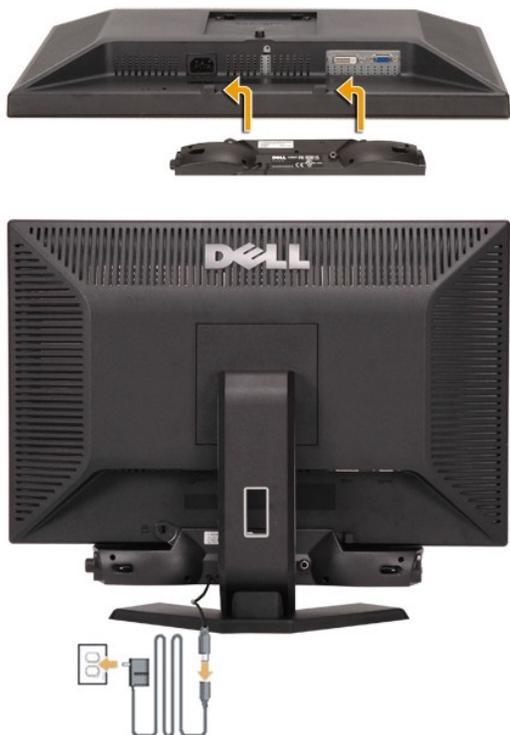
1. Sur l'arrière du moniteur, fixez la Sound Bar en alignant les deux orifices avec les deux languettes sur le bas à l'arrière du moniteur.
